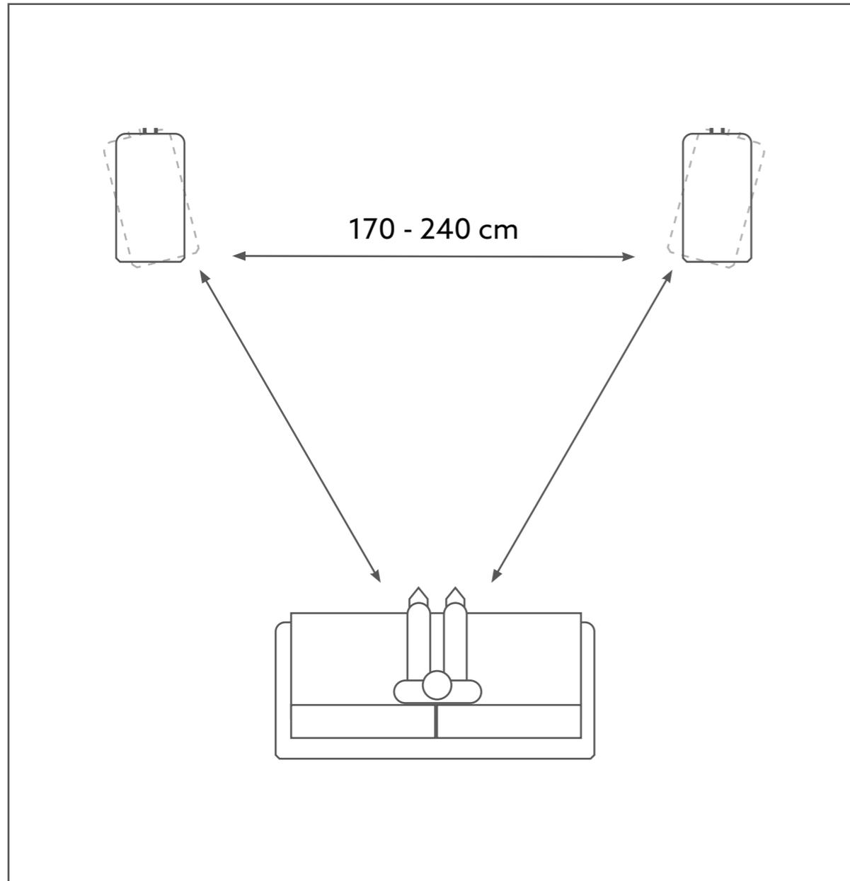
Die Position der den Lautsprecher umgebenden Raumwände hat Einfluss auf den Klang des Lautsprechers. Je mehr Wände und Oberflächen sich in nächster Nähe der Lautsprecher befinden, desto stärker ist die Wirkung der Tiefton- und tiefen Mitteltonfrequenzen.
