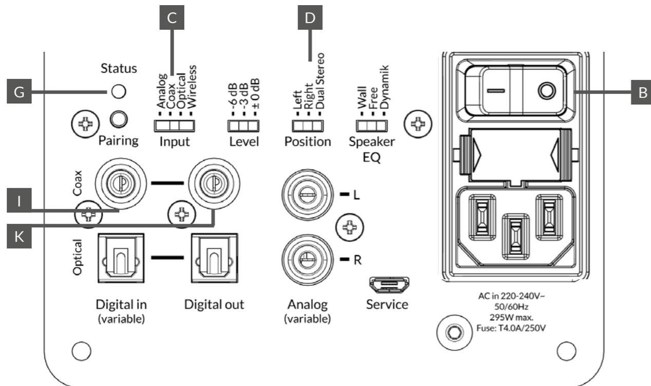
1. Select under „Input“ [C] the position „Coax“ at both power amplifiers, set the „Position“ [D] with left „left“ or right „right“.
