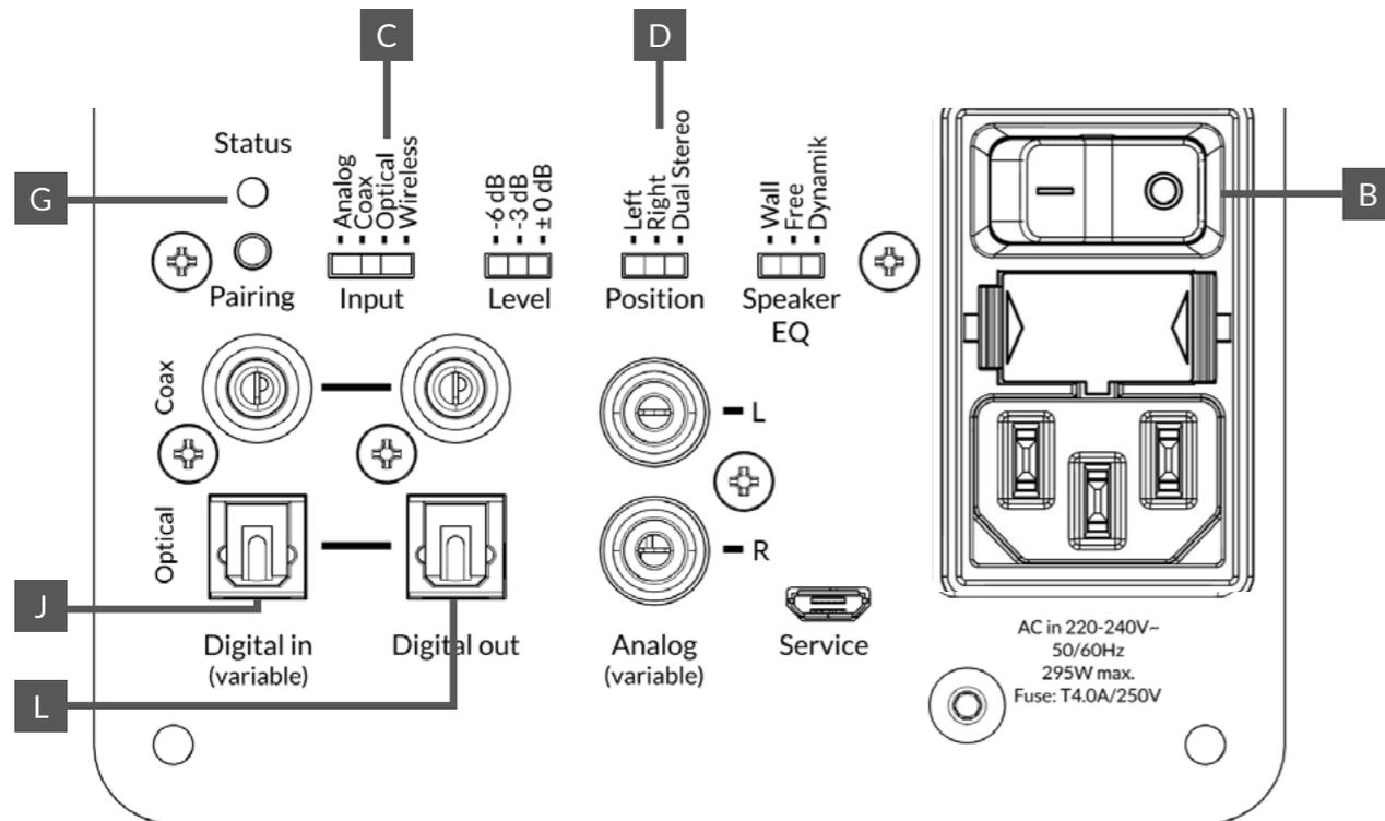
1. Select the position „Optical“ under „Input“ [C] at both power amplifiers, set the „Position“ [D] with left „left“ or right „right“.
