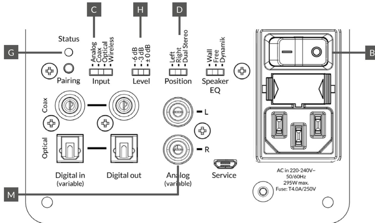
1. Select under „Input“ [C] the position „Analog“ at both power amplifiers, set the „Position“ [D] with left „left“ or right „right“.
