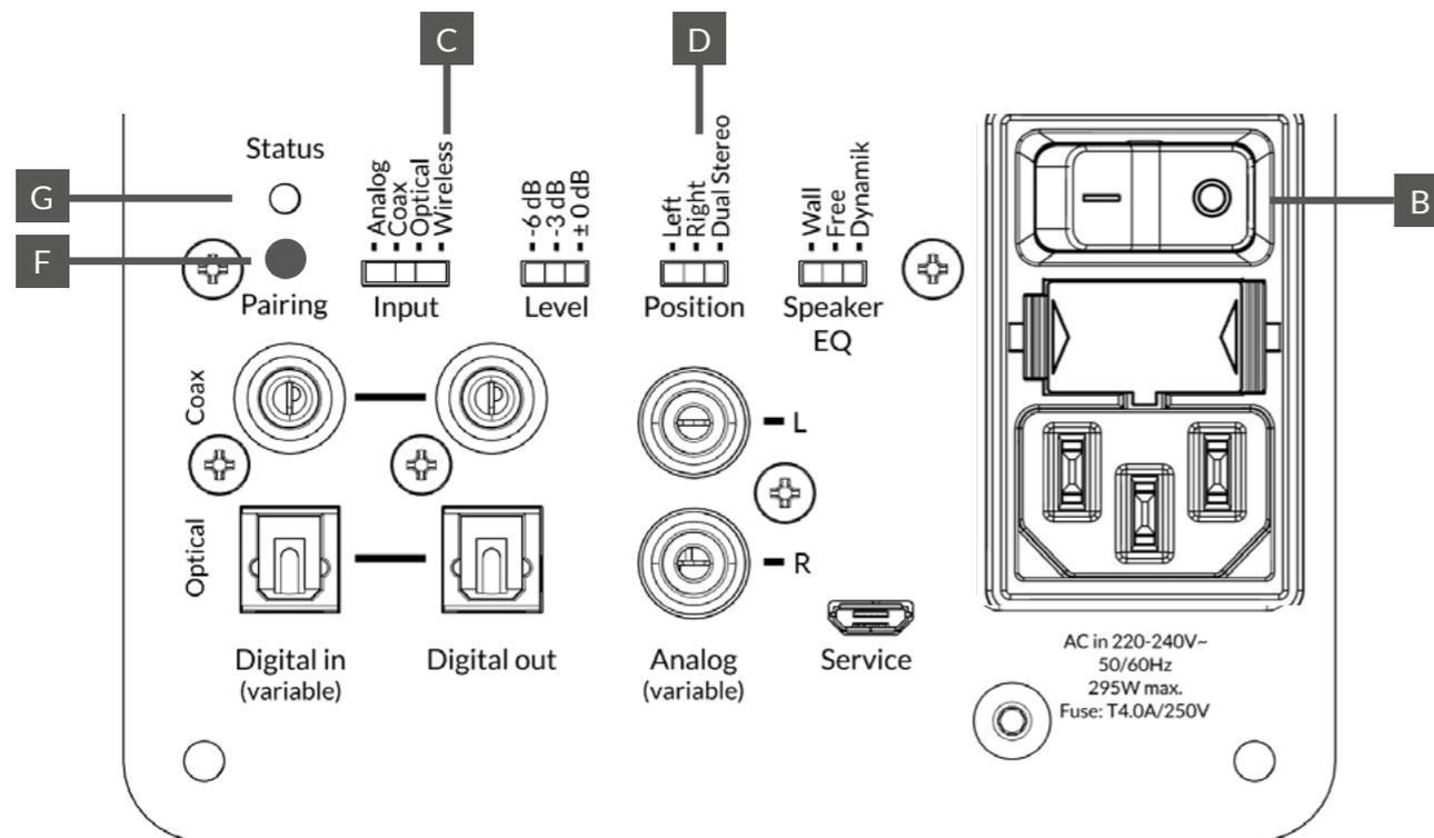
1. Wählen Sie unter „Input“ [C] die Position „Wireless“ an beiden Endstufen, legen Sie die „Position“ [D] mit links „left“ bzw. rechts „right“ fest und schalten Sie die Endstufen ein [B]. Die Status-LED [G] leuchtet gedimmt blau.
