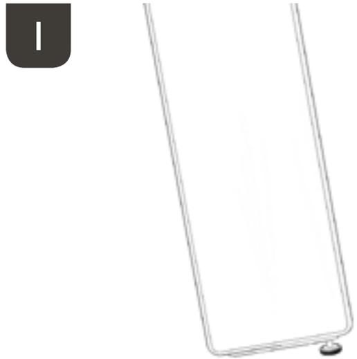
**I** Kippen Sie den Lautsprecher leicht zu einer Seite an. Drehen Sie zwei der vier Füße ein, indem Sie diese in die Gewindelöcher an der Lautsprecherunterseite schrauben. Drehen Sie die Füße vollständig ein und setzen Sie den Lautsprecher vorsichtig ab.
