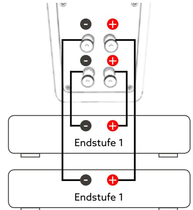
Alle Modelle der AdvancedLine sind mit jeweils zwei Paaren Anschlussklemmen ausgestattet. Sie ermöglichen den Betrieb mit zwei Endstufen (Bi-Amping) oder die Nutzung der Lautsprecheranschlüsse A + B an Ihrem Verstärker (Bi-Wiring). Entfernen Sie für diese Betriebsarten die montierte Verbindungsbrücke. Für den klassischen Betrieb bleibt die massive Verbindungsbrücke montiert.
